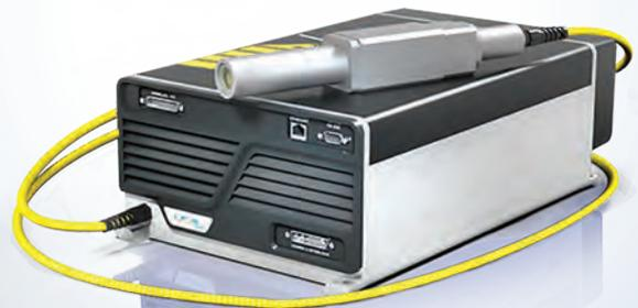
Наносекундный иттербиевый оптоволоконный лазер **ИЛМИ-2-300** производства НТО "ИРЭ-Полюс" генерирует наносекундные импульсы длительностью от 20 до 500 нс со средней выходной мощностью до 300 Вт и управляемой в диапазоне от 2 до 4000 кГц частотой следования. Энергия в импульсе 2 мДж и полностью воздушное охлаждение делают данный источник – идеальным решением для мобильных установок лазерной очистки и высокопроизводительной маркировки.
