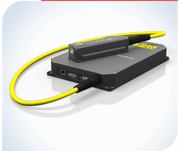
Приборы серии **VLM** – серийно производимые нашей компанией высокоэффективные непрерывные **одномодовые** волоконные лазеры, принцип действия которых основан на явлении вынужденного комбинационного рассеяния с последующим эффективным преобразованием излучения в нелинейно-оптическом кристалле.
