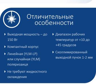
Серии **YLM и YLM-LP** представляют собой семейство высокоэффективных непрерывных маломощных одномодовых волоконных иттербиевых лазеров. Источники способны генерировать излучение в диапазоне длин волн **1010 – 1090 нм** с выходной мощностью до **150 Вт**.
