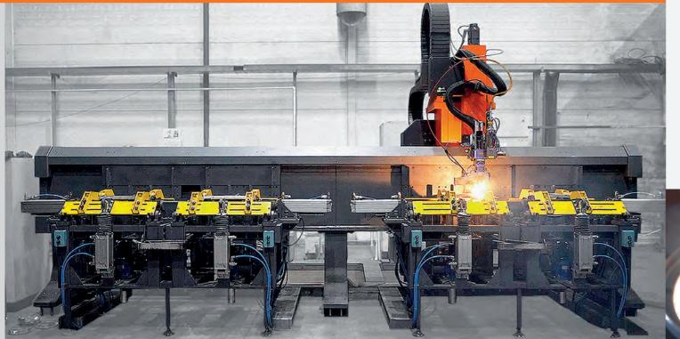
Блок лазерной сварки с проволокой – специально спроектированная, компактная многофункциональная оснастка для промышленных оптических головок лазерной сварки. Насадка полностью совместима с головками FLW D50.
