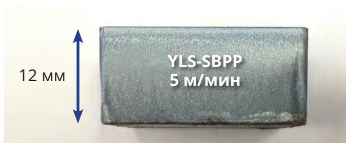
Лазерный раскрой, лазер YLS-40000-SBPP
