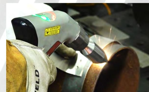
Высокопроизводительный режим очистки до и после сварки
